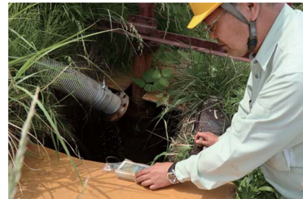
地下に浸透した雨水と鉱石が触れることによって重金属を含む酸性水が発生することがあります。休廃止となった鉱山でも、周辺の湧水のモニタリングが欠かせません。
